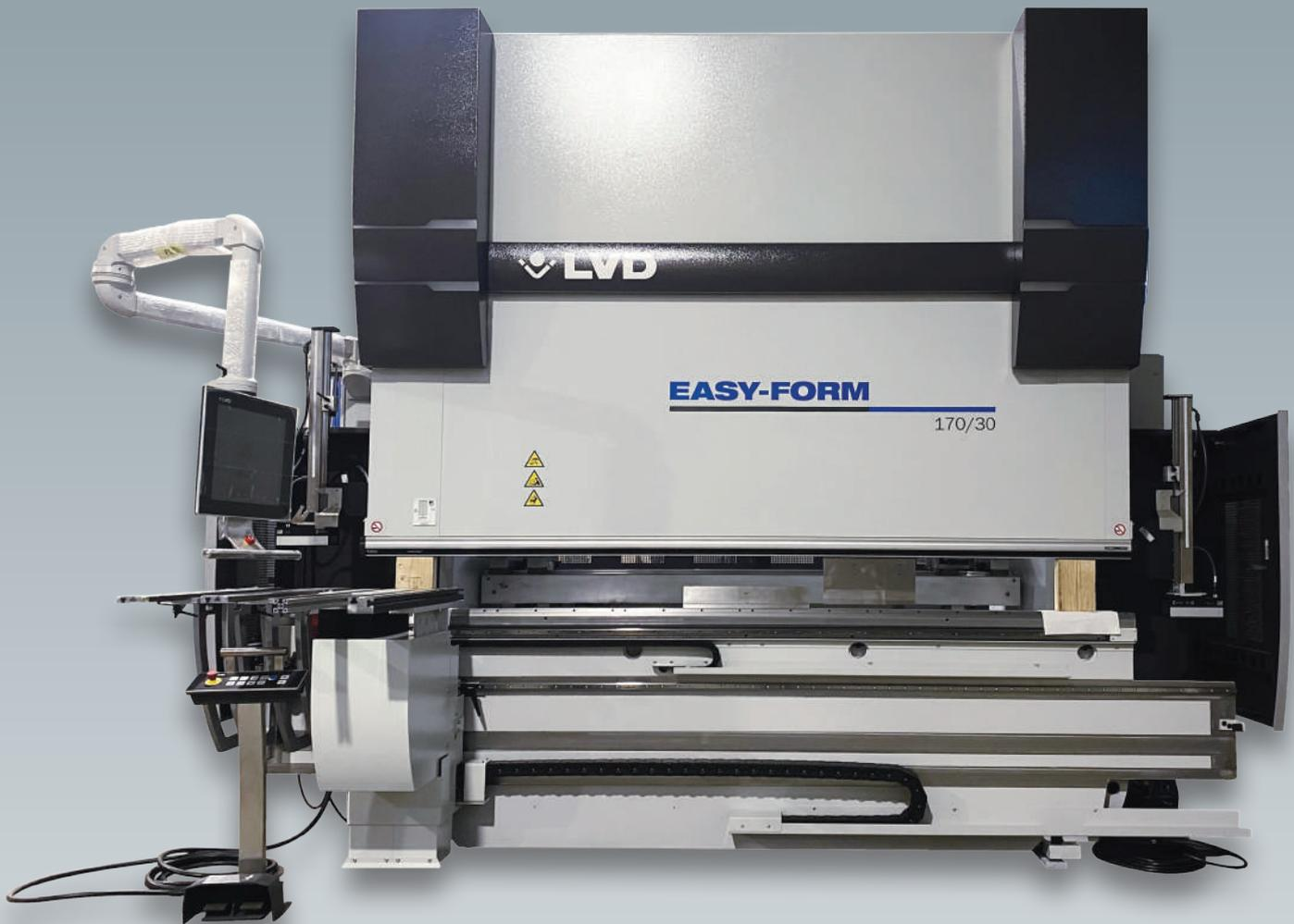
La piegatrice di ultima generazione è dotata di sistema brevettato per la correzione e il monitoraggio dell'angolo all'interno del processo.
